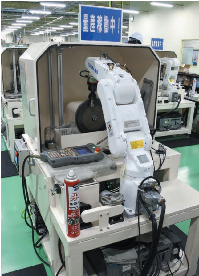
研磨作業の負担を軽減するため、ロボットも導入
