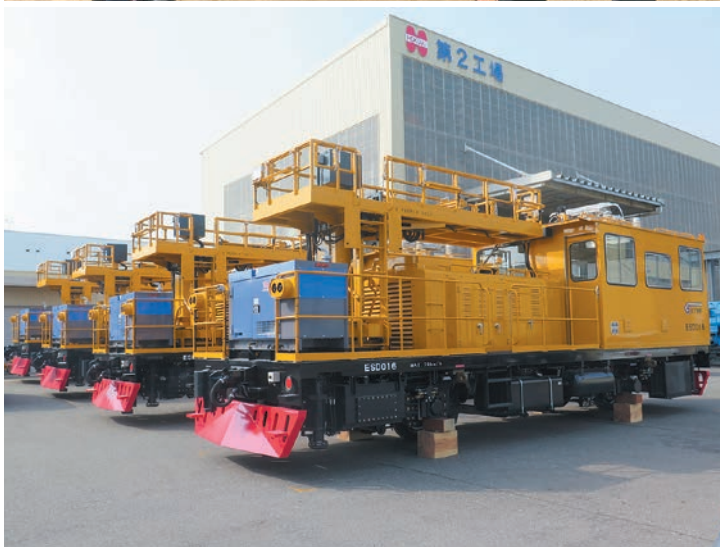
(上) 2017年に実施されたベトナム鉄道の踏切遮断機設置の様子。 (下) 2018年10月にマレーシア鉄道公社に納入した架線検測車。 ODA以外の海外案件で、同社が顧客とのリレーションを構築し、 オーガナイザー（まとめ役）機能を発揮した代表的な案件。
