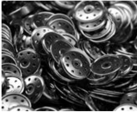
無電解ニッケルめっきをほどこしたHDD(ハードディスクドライブ)部品
