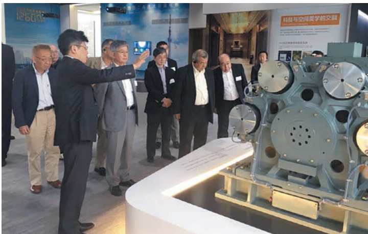
日立電梯の巻き上げ機
