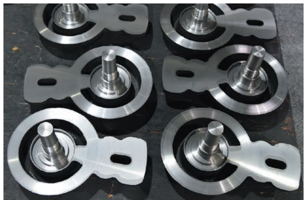
(上) 本社に隣接する工場で。(下) 組立加工を待つ「逆洗アーム」。フィルターの逆洗浄時に機能する。
