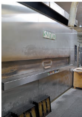
店舗奥の工場にある、おいしく焼き上げるのに不可欠な大型のリールオープン（左）。焼き加減をそのつど確認しながら、パンの位置や焼成時間などの調整を行う
